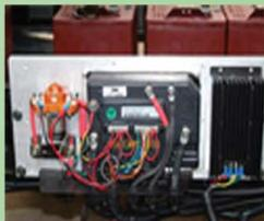
Contrôleur : ZAPI (Italie). Le Contrôle s'effectue par un programme ordinateur (vitesse, accélération et décélération) ainsi que le freinage électrique. Le freinage s'effectue en douceur. Vous pouvez appuyer sur le bouton switch OFF ou couper la puissance frein moteur).
