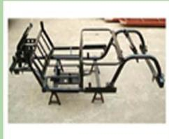
Chassis : En acier tubulaire spécial avec traitement anti-corrosif, très résistant. Résistance supérieure à l'aluminium.
