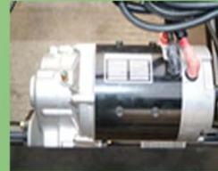
ADC Moteur : Moteur original, fabrication ADC USA. 3,7 Kw. Basse température de fonctionnement, montée en température lente. Durabilité : cuivre de haute qualité pour le stator et le rotor.
