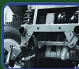
*Nos golf cars ont un style de suspensions apparenté aux automobiles, ressorts hydrauliques montées sur support aluminium. Les roulements sont lubrifiés en permanence. En sus, la voiturette bénéficie d'un système SPLASH-VALUE qui permet de se passer du filtre à huile.*
